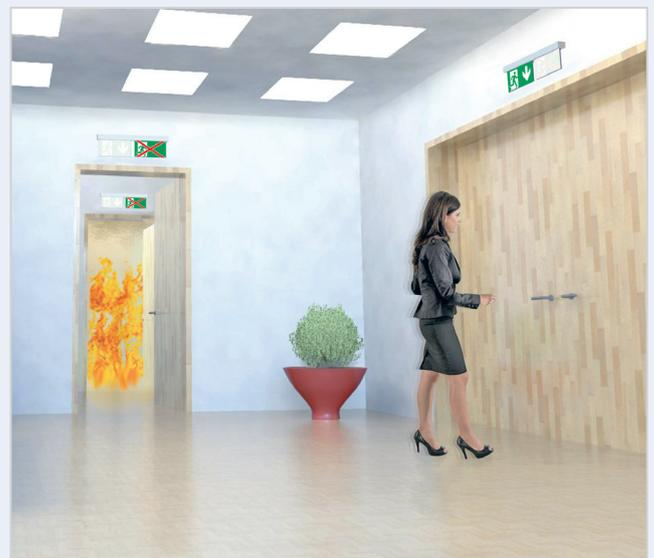
*Wird ein Brand durch die Brandmeldeanlage detektiert, können die Pfadfinder-Leuchten flüchtende Menschen sicher aus der Gefahrenzone leiten. Hierzu wird nun der alternative 2. Fluchtweg ausgewiesen. Die Kennzeichnung des 1. Fluchtweges in den Gefahrenbereich ist nun blind.*
